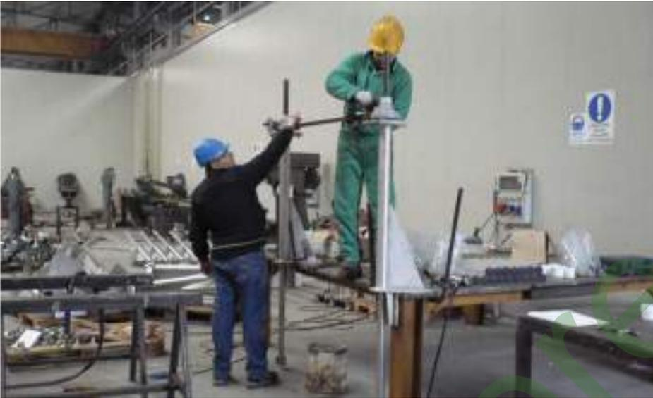
soulevée ne dépasse pas le niveau d'installation est nécessaire d'utiliser la **colonnnette de manœuvre**. Ce cas, moins fréquent, se vérifie si le canal est beaucoup plus profond par rapport à la hauteur d'eau dans le canal pas très élevée. Dans le cas on utilise la colonnette de manœuvre, il est nécessaire considérer que l'installation de la même peut être à **paroi** ou au **sol**.
