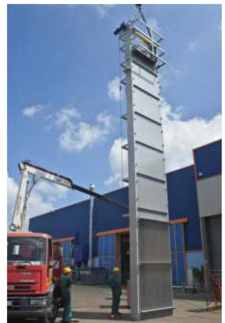
➔ Dégrilleur plat vertical à câble GPSC
