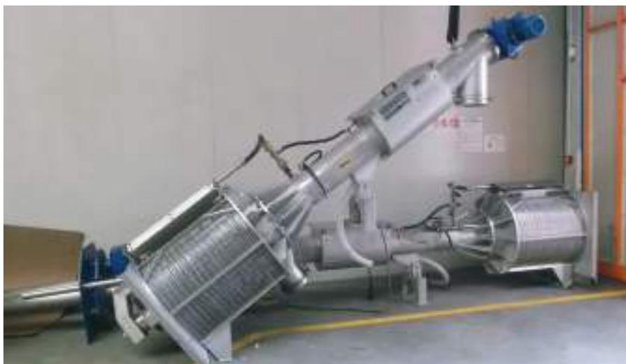
→ Vue d'ensemble du système avec filtre à vis FSS → Filtre à vis FSS
