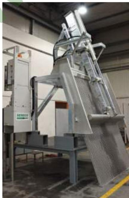
→ Dégrilleur vertical hydraulique GVI
