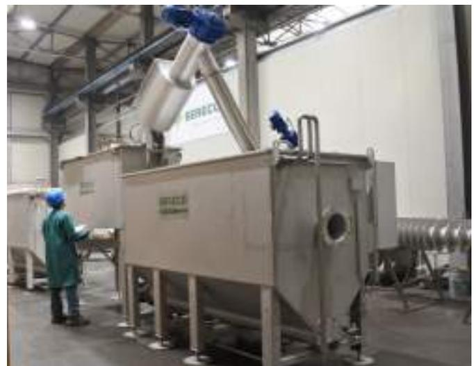
➔ Station compacte intégrée de prétraitement
