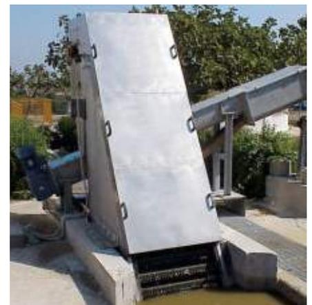
→ Vue d'ensemble de station avec dégrilleur à bande à dent plate GNP
