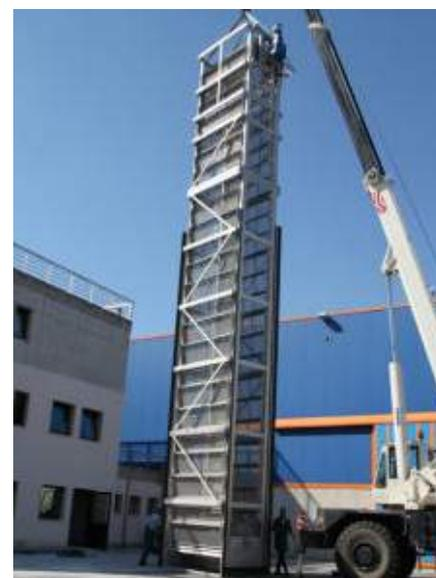
→ GDégrilleur à bande à flux lateral GNAFO1, essai en usine
