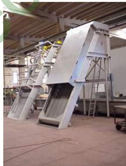
→ Dégrilleur plat sub-vertical à mouvement alterné GPSA
