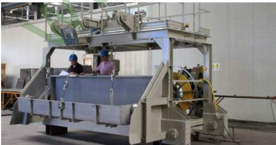
→ Dégrilleur automatique à benne pendulaire SGPSA
