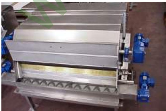
➔ Dégrilleur à tambour avec vis de compactage incorporée GRSC
