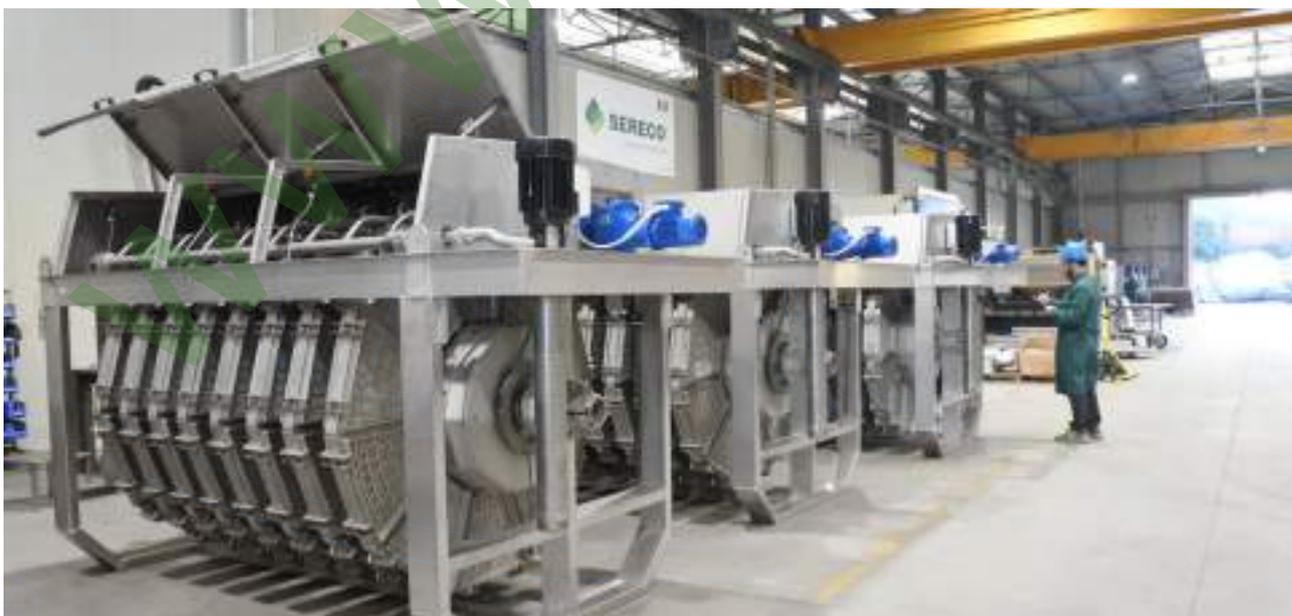
→ Filtre à disque à gravité avec filtration de l'intérieur vers l'extérieur
