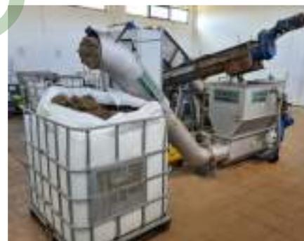
➔ Laveur et compacteur-convoyeur du matériau de dégrillage à vis
