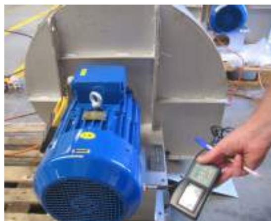
→ Ventilador centrífugo para el control de olores
