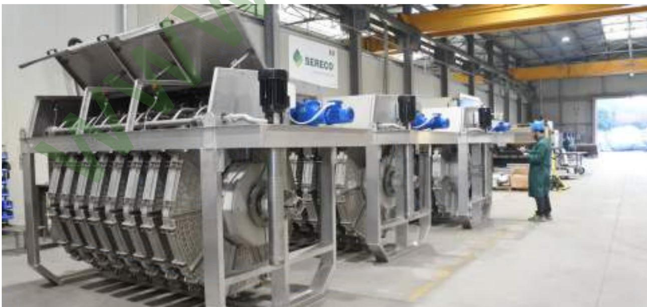
→ Filtro de discos por gravedad con filtración desde el interior hacia el exterior
