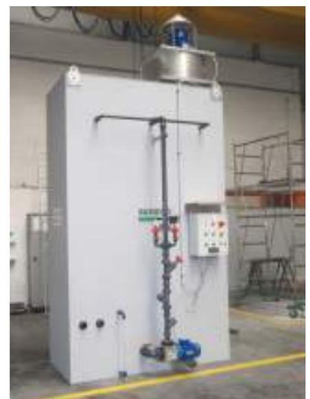
→ Lavador de gases para la reducción de Cl<sub>2</sub> en el aire
