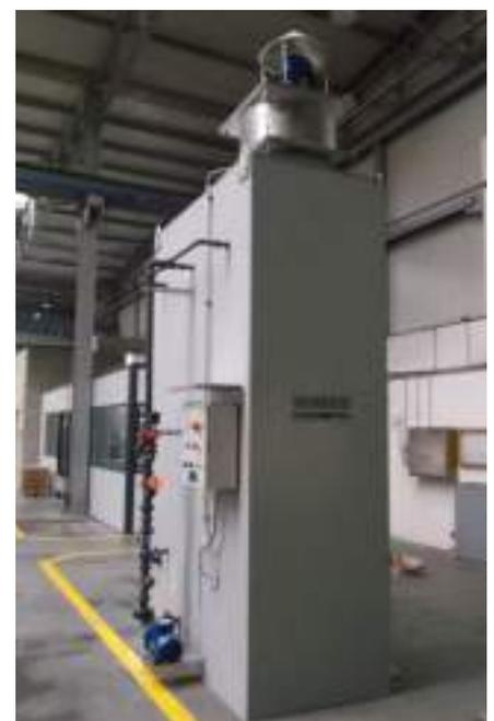
→ Lavador de gases para la reducción de H<sub>2</sub>S
