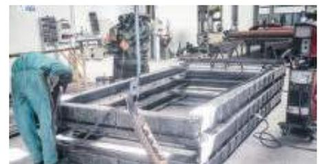
Fase de comprobación de la construcción de algunas compuertas.
