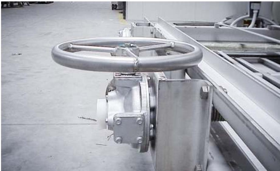
**operatore.** Esse possono essere realizzate nella **versione con volantino**, oppure in quella con **riduttore di giri e volantino**. La scelta della presenza o meno del riduttore di giri è **effettuata direttamente dai tecnici SERECO**, in base alla forza necessaria per l'azionamento e in base agli standard ANSI/AWWA C560-00, C540-02, C561-04 e C513-05. Su richiesta è possibile installare il riduttore di giri anche in caso non sia strettamente necessario dal calcolo.
