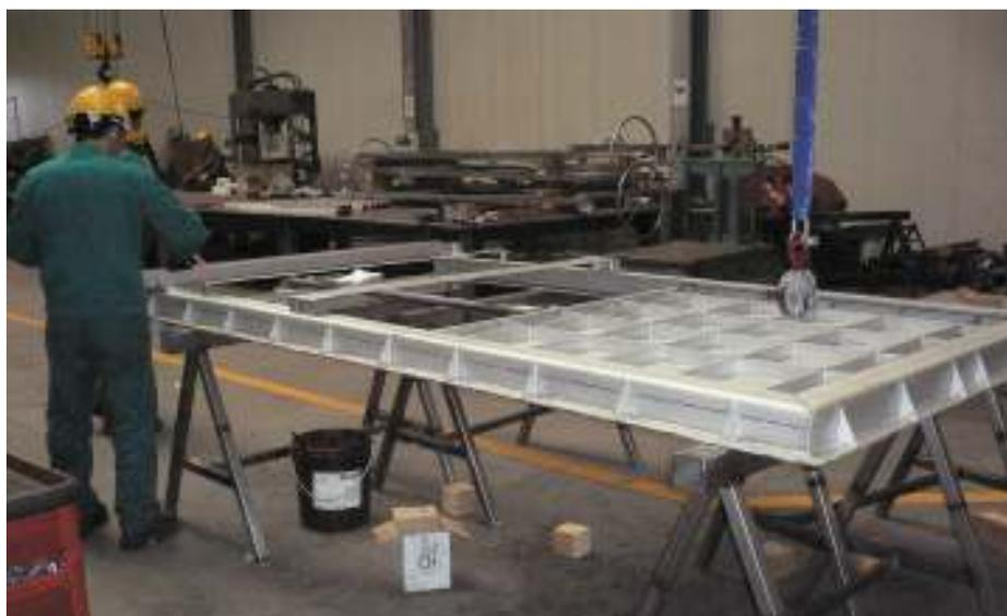
Le paratoie sono macchine sempre presenti all'interno di qualunque sistema idrico; la loro presenza consente di controllare il percorso dei fluidi mediante l'intercettazione e il convogliamento degli stessi. Le paratoie consentono, infatti, di aprire e chiudere percorsi all'interno dell'impianto, rivestendo quindi un'importanza fondamentale nella gestione dello stesso.
