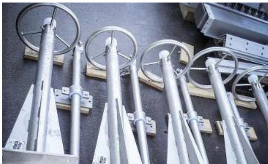
fondo che sarà inghisato nella risega a mezzo di calcestruzzo di riempimento. Il fissaggio del fondo a mezzo ancoranti non sarebbe, infatti, possibile per la difficoltà (a volte impossibilità) di effettuare i fori di fissaggio.
